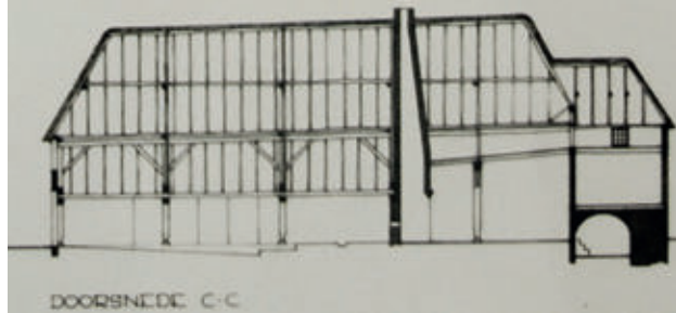
Doorsnede in de lengterichting van de Armenhoeve. De omhooglopende zolderhoogte is opmerkelijk. (Tekening SHBO)
