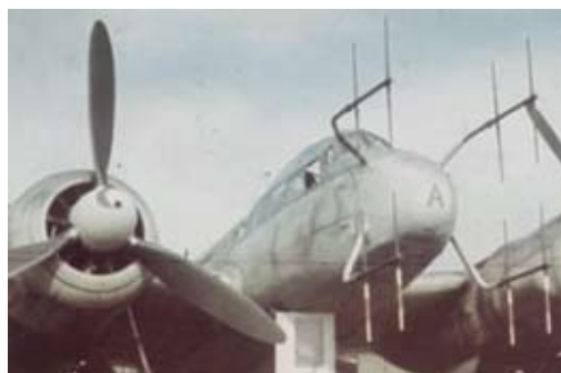
Een Junkers Ju88G-1 nachtjager zoals deze op het vliegveld Volkel stonden. Duidelijk zijn op de neus van het toestel de antennes van de SN-2 radar zichtbaar
