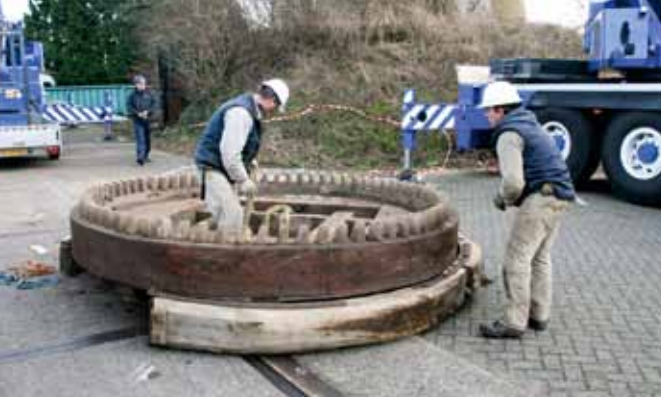
Twee molenmakers zien een gaaf kroonwiel met remvang (foto ER, 4.2.2014)
