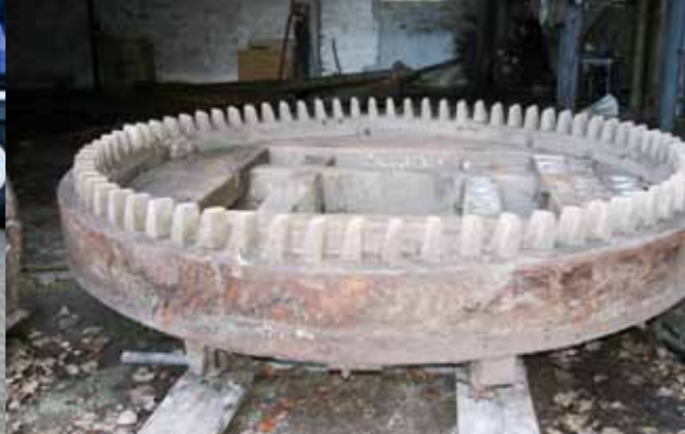
Twee molenmakers zien een gaaf kroonwiel met remvang (foto ER, 4.2.2014)
