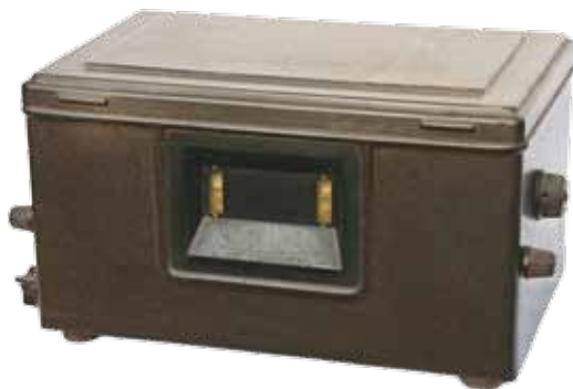
Philips 2534 uit 1930 (prijs f 125), kon op het lichtnet worden aangesloten, ontving zowel midden- als lange golf. Te oordelen naar het aantal in 1943 ingeleverde exemplaren was dit in Gemert de meest populaire radio. (Collectie: auteur)
